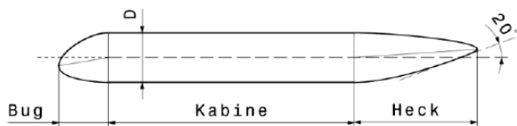
BILD 10: Generisches Rumpfmodell mit einem Passagierdeck für Parameterstudien
