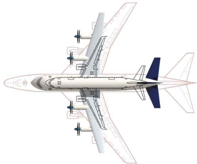
BILD 29: Größenvergleich der finalen Konfiguration zu Boeing 747 Domestic (rot) und Airbus A320 (schwarz)
