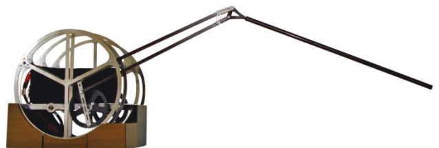
BILD 31. Funktionsmodell des Biegetorsionsantriebs
