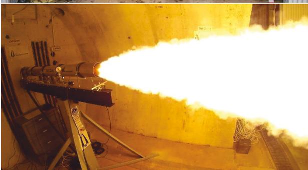
BILD 16. Motorprüfstand in horizontaler Konfiguration
