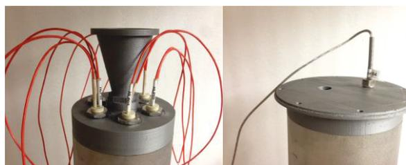
BILD 9. Integrationstests der Heizstäbe und des Temperatursensors
