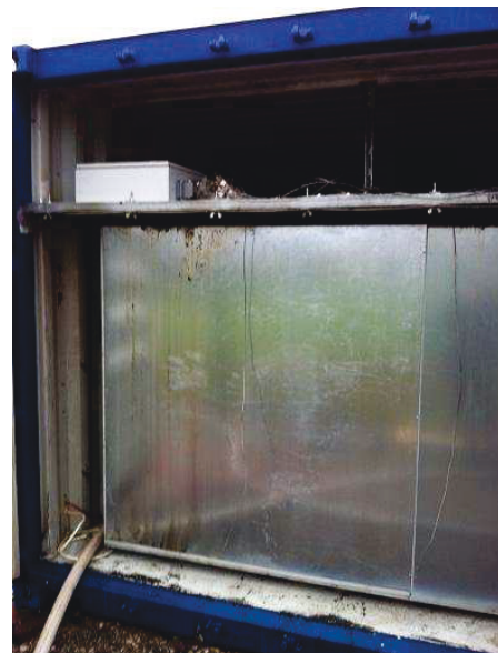
BILD 2. Frachtcontainer im Teststand. Zu beachten ist der geringe Abstand zwischen Container und abgehängter Decke.
