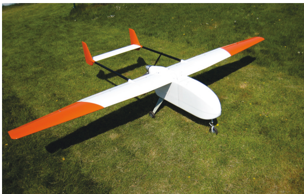
Abb. 5: Carolo P360, Spannweite 3.6 m, Masse 25 kg
