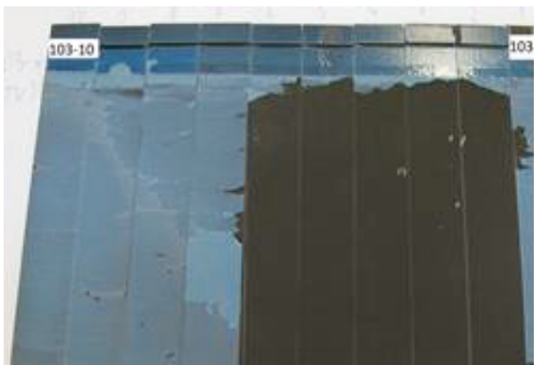
BILD 8. Bruchverhalten von DCB Proben ohne Alterung bei Verwendung des TV Peel Plies und eines Pastenklebstoffs
