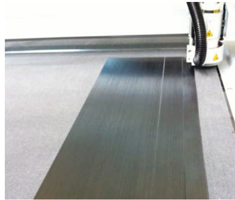
BILD 8: Einreißen des UD-Tapes beim manuellen Auflegen auf das Cutterband.
