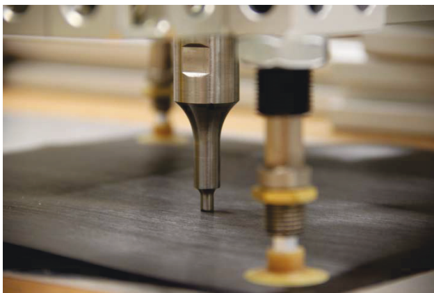
BILD 16: Kombiniertes Greifen und Heften mittels US.
