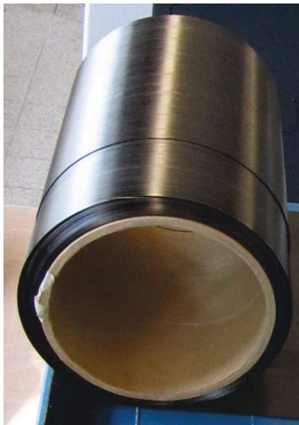
BILD 4: 12" breites CF/PEEK UD-Tape der Fa. TenCate, aufgerollt auf einem Pappkern mit 6" innerem Kerndurchmesser.
