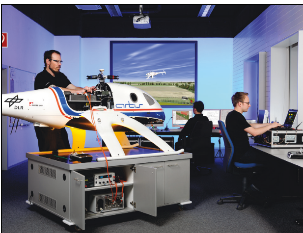
BILD 6: Aufbau HIL-Simulation und Visualisierung
