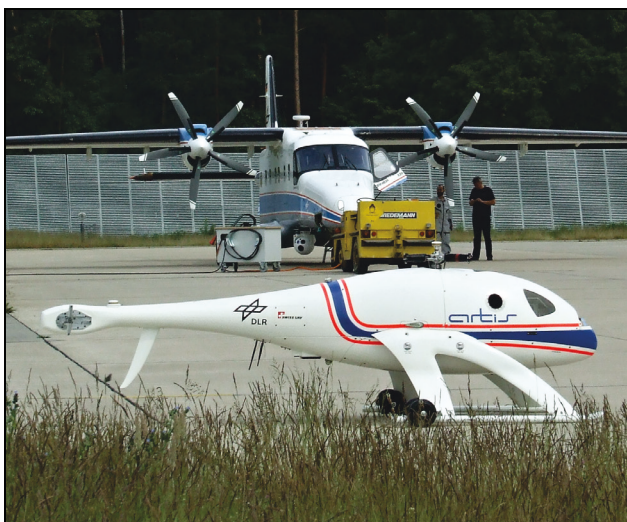
BILD 10: EMV-Test mit Do 228 und Bodenstationen
