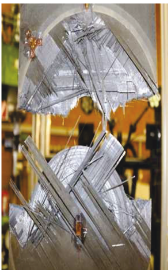
BILD 12: Zerstörender Test an einem geklebt reparierten Faserverbundtestartikel
