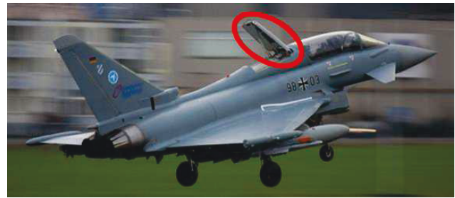
BILD 4: Luftbremse, als Demonstratorstruktur „Strukturelle Klebtechnologie“
