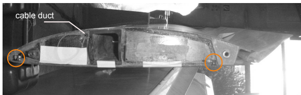
BILD 4: Anbringung der Sensoren S1 und S2 am Außenflügel mit Darstellung des Kabelkanals
