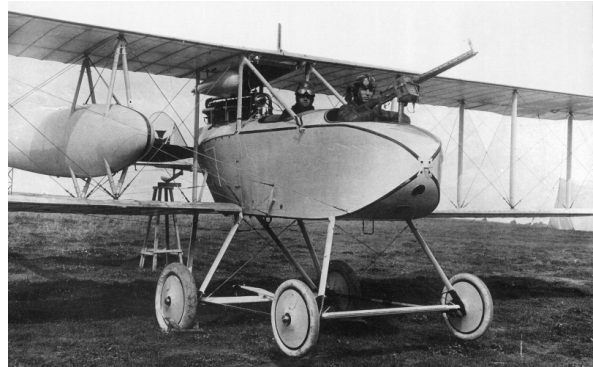
Ago C.I. Im Bug unterhalb des Ago-Emblems ist schwach der Ausschnitt für die Luftbildkamera zu erkennen.
