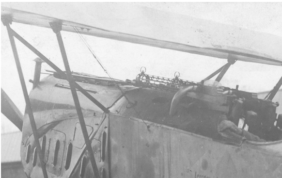
LMG 08/15 in einer Fokker D.VII.
