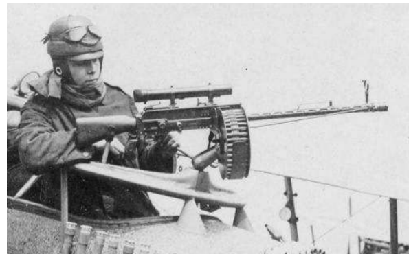
Fliegerschütze eines Schlachtfliegers mit seinem LMG 14/17 "Parabellum", in der Ausführung mit Zielfernrohr.
