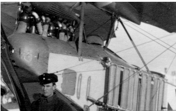
Seitlicher Elementkühler bei Albatros B.I, (1913).
