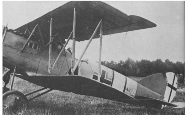
Pfalz D.XII mit Hornausgleich an Seiten-, Höhen- und Querrudern.
