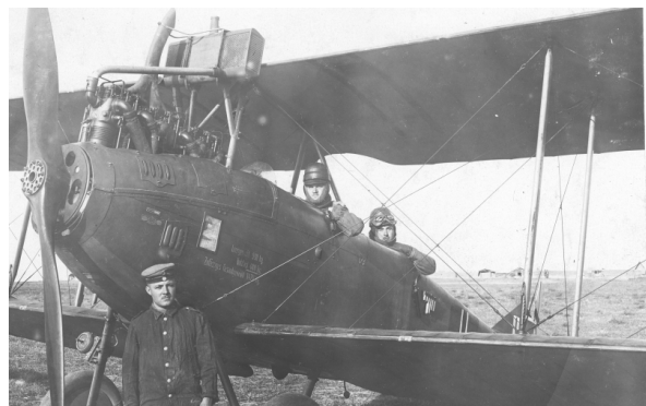
DFW C.V als Artillerieflugzeug. Unter dem Rumpf ist das sogenannte "Antennen-Ei" zu sehen, ein Gewicht am Ende der Antenne, um diese im ausgefahrenen Zustand in die Vertikale zu bringen. Der Generator für die FT-Anlage befindet sich an der Fahrwerksstrebe steuerbord vorne. Außen am Rumpf unterhalb des Beobachters ist eine Signalpistole angebracht als Rückfalloption bei Ausfall der FT-Anlage.
