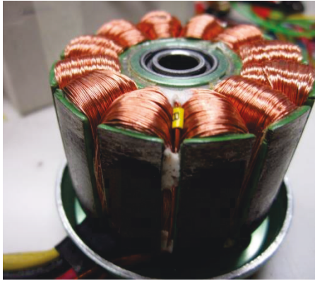
Bild 2-1 Temperaturmessung der Wicklungen
