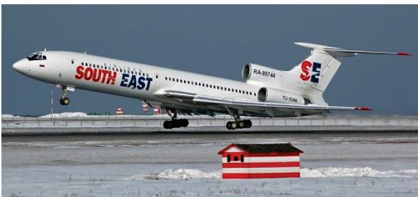
BILD 7. Auch bei der TU 154 befinden sich am Heck 3 Triebwerke auf insgesamt ähnlicher Längenposition [23]
