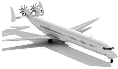
BILD 2. Beispiel einer der bisherig vorgeschlagene Flugzeugkonfiguration, welche die Open-Rotor Antriebstechnologie nutzen [12]
