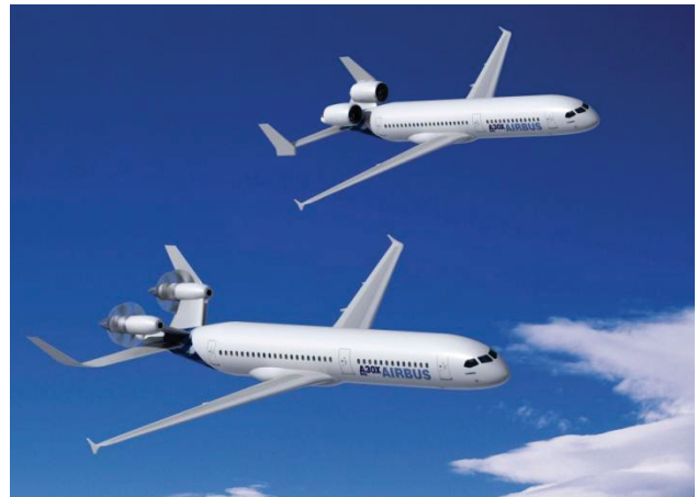
BILD 3. Die Platzierung von Open-Rotor-Triebwerken wie bei Turbofantriebwerken direkt nebeneinander birgt die Gefahr das im „Rotor Burst Falle“ eines Triebwerks, beide Triebwerke durch Bruchstücke der Rotoren beschädigt werden [13]
