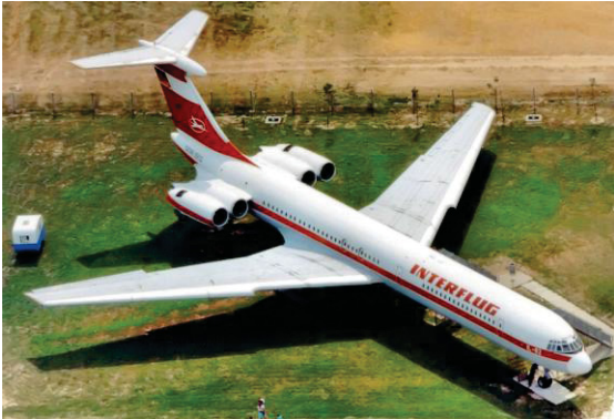
BILD 6. Bei der Il 62 sind am Heck jeweils 2 Turbofantriebwerke direkt nebeneinander plaziert [16]
