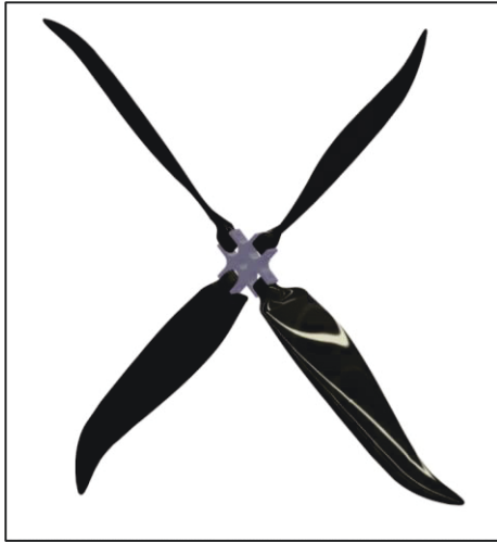
TAB 3. CAD-Modell des entwickelten lärmarmen 4-Blatt Propellers
