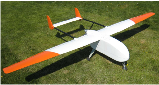
Abbildung 1: Unbemanntes Flugsystem CAROLO P360 .
