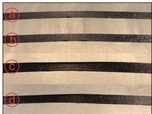
BILD 7: Beulen am Innenradius (a und b) und Lösen am Außenradius (c und d)
