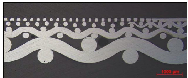
BILD 10. Schliffbild hybride Außenhaut
