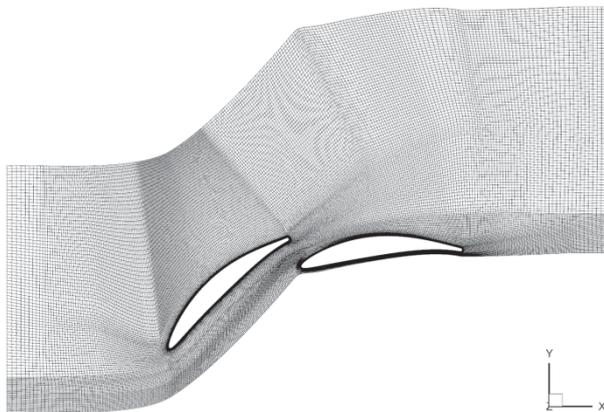
BILD 6. Rechenetz der hochumlenkenden Tandemkaskade
