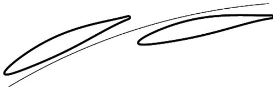
BILD 15. Niedrigumlenkende Tandemkaskade
