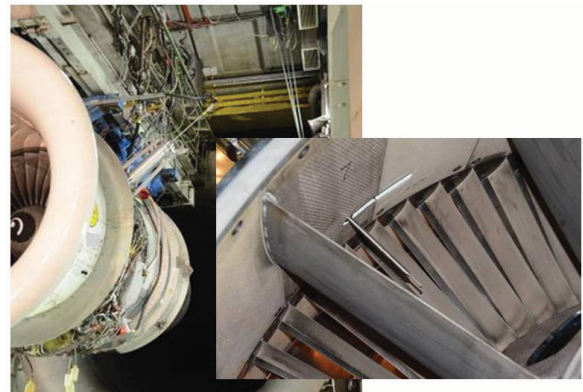
BILD 15. Montage der Messsonde mit Verstellvorrichtung am Triebwerksprüfstand
