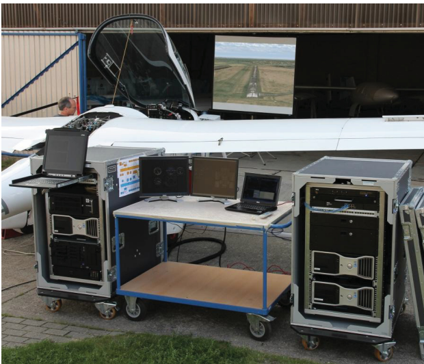
BILD 7. Betrieb des HIL-Simulators an der S15
