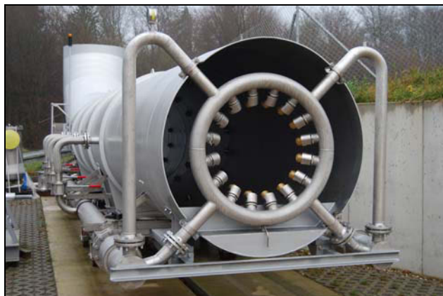
BILD 1. Leitrohr P8 in Parkposition. Vorne ist der 1. Einspritzring mit einem Durchmesser von 1,09m mit Verteilerrohr zu sehen. An der linken Seite sind die Wasserzuführungen der Einspritzringe 2-5, die symmetrisch hierzu auf der rechten Seite zu finden sind.
