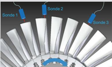
Schema zur Messung der Schaufelschwingungen
